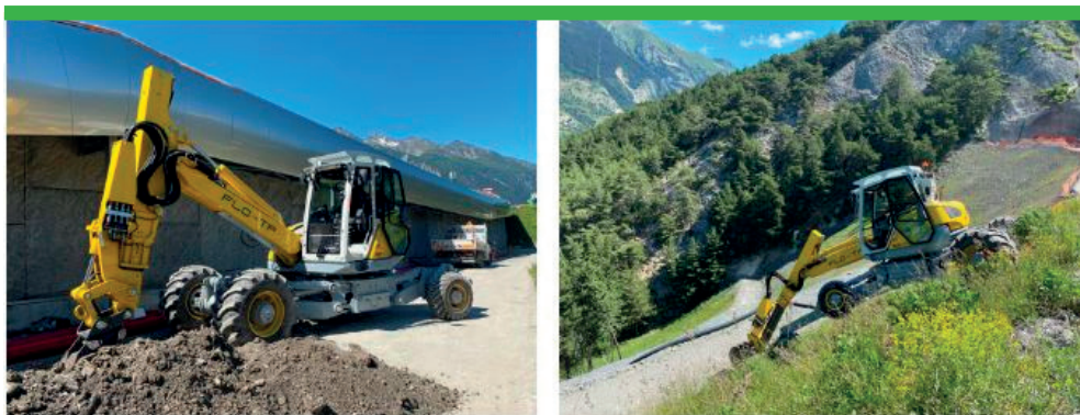
Une partie des travaux a été réalisée à l'aide d'une pelle araignée pour les espaces difficilement mécanisables.
