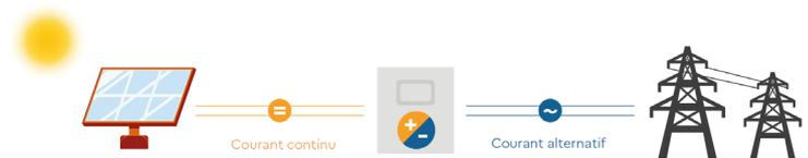
Source : Synoptique simplifié d'une installation photovoltaïque avec les différentes unités de puissance - ADEME
